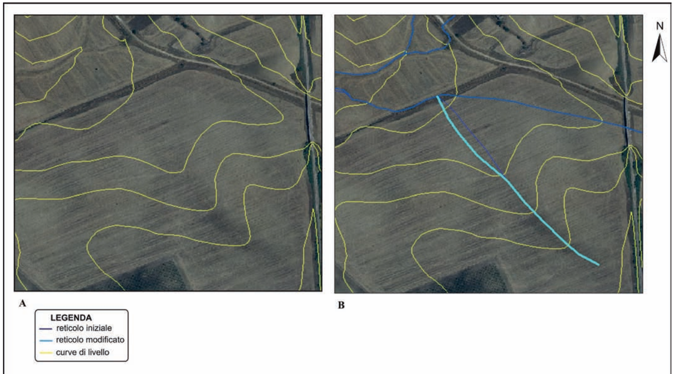
Figura 10 – Esempio di un tracciamento più preciso (in scala 1:5.000) di un tratto di un corso d’acqua.
