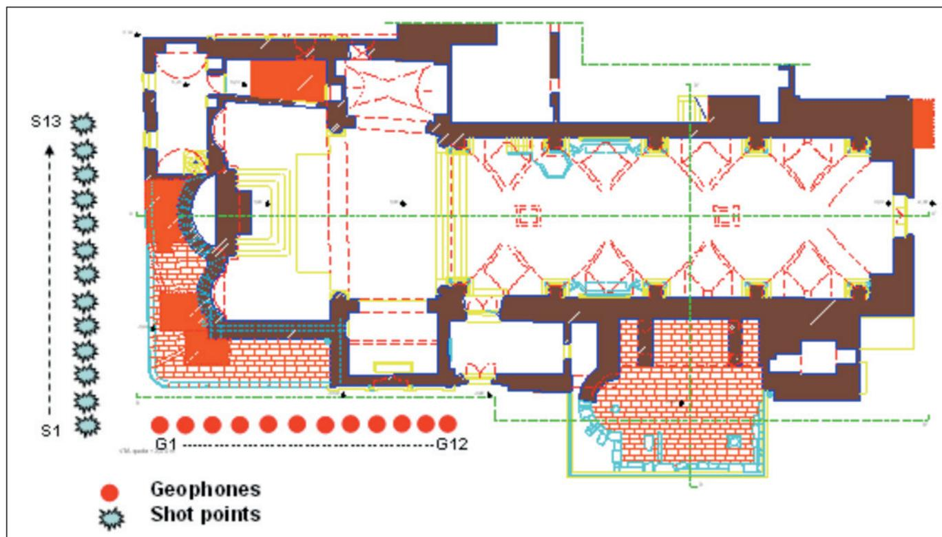
Figura 4 - Geometria di acquisizione dei dati di tomografia sismica a rifrazione.
