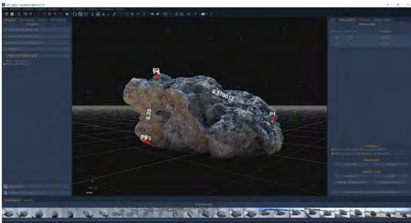
Figura 5 - Elaborazione dimensionale mediante il software 3DF Zephyr del masso M 2 . Le distanze sono espresse in metri.
