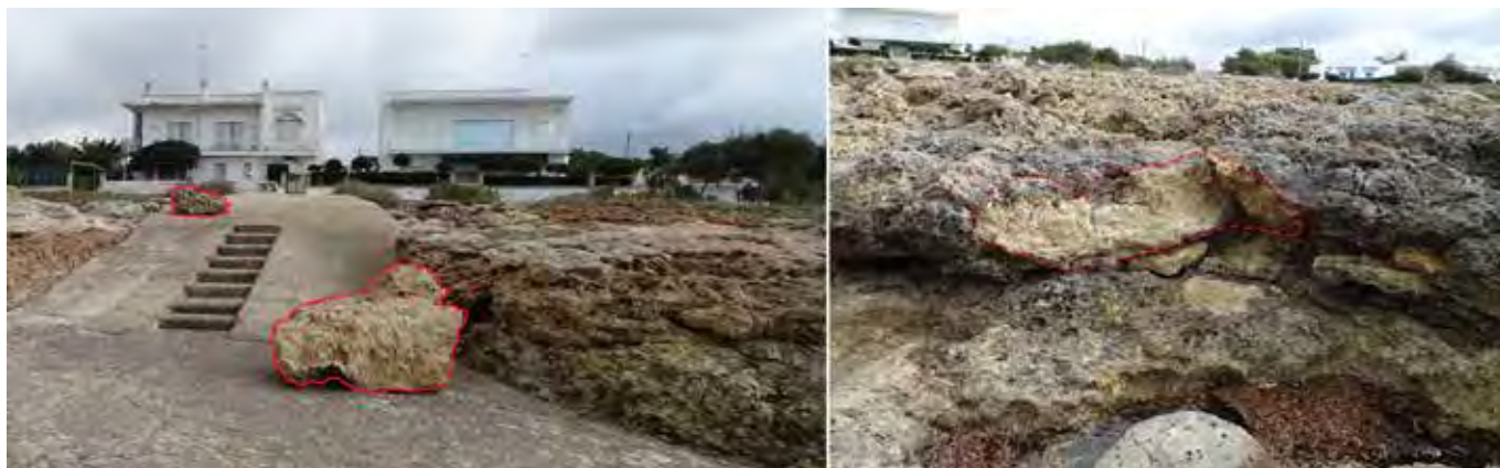
Figura 3 - A sinistra, al centro della foto il masso M_1 , sullo sfondo M_2 ; a destra la nicchia di distacco (da Mangia, 2019).
