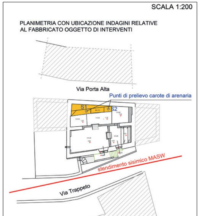
Figura 7 - Ubicazione dei punti di prelievo dei campioni per le prove geotecniche e dell'indagine sismica integrativa - anno 2018-2019.
