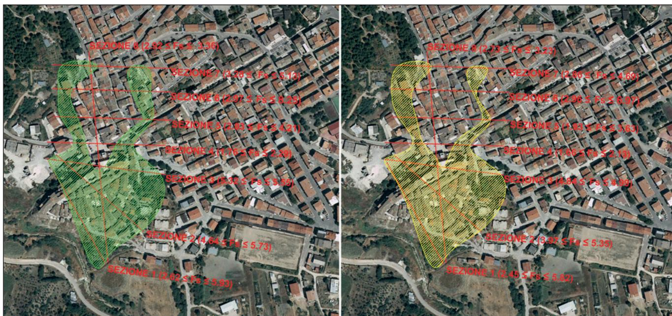
Figura 12 - Possibili perimetrazioni su ortofoto delle aree a maggior rischio di frana: in condizioni statiche (campitura verde a sinistra) e in presenza di sisma (campitura gialla a destra); con range di variazione dei 10 Fs più bassi ottenuti per ogni sezione di verifica.
