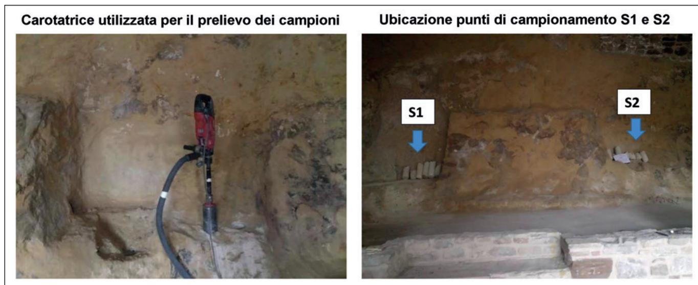
Figura 8 - Carotatrice utilizzata per il prelievo dei campioni ( $\varnothing=100\text{mm}$ ,  $L=110\div 270\text{ mm}$ ) e ubicazione dei punti di campionamento nell'affioramento di arenaria presente all'interno del piano seminterrato di un edificio prospiciente Via Trappeto (vedi Fig. 7).
