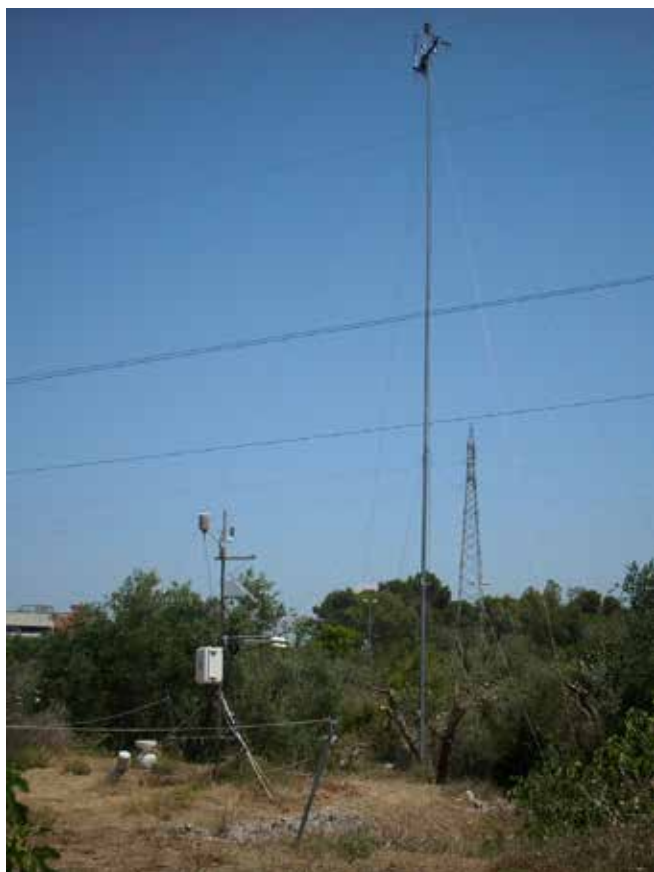
Figura 9 - La base micrometeorologica ISAC-CNR. A sinistra, la stazione meteorologica automatica utilizzata per il monitoraggio della precipitazione, della radiazione solare, dei parametri del suolo, e di altre variabili meteorologiche (temperatura, pressione, umidità, vento). A destra, il palo telescopico che ospita alla sua sommità il sistema di misura ad eddy-covariance per l'evapotraspirazione.
