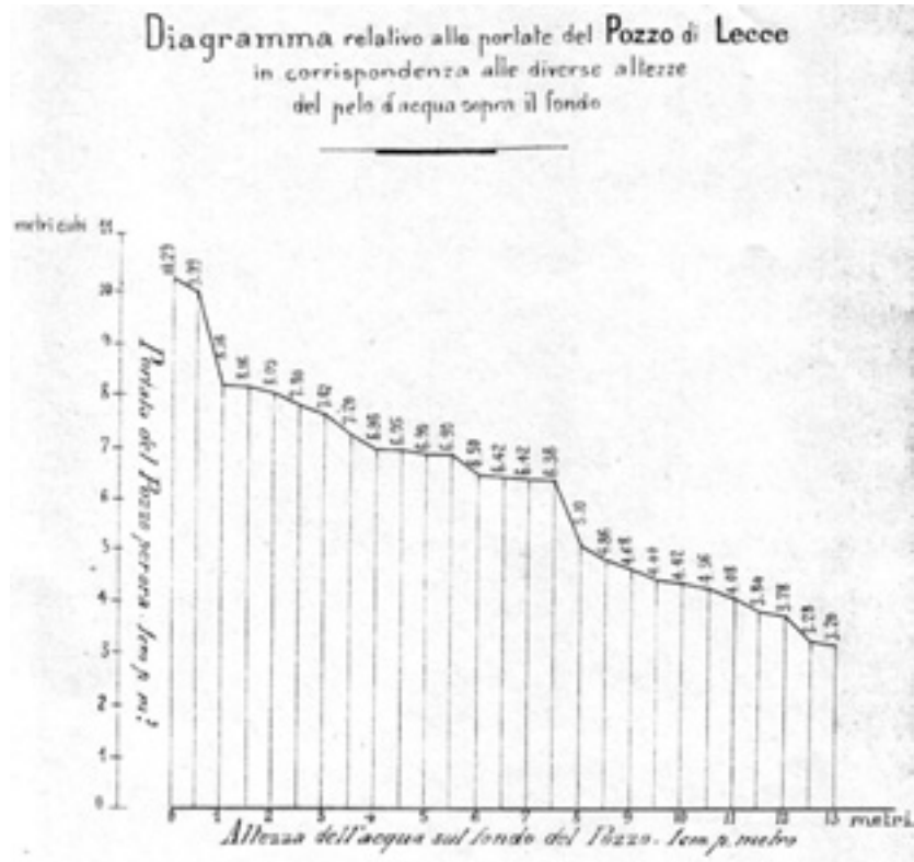
Figura 3 - Prove di portata eseguite nel pozzo della ferrovia nel 1888 (Archivio Storico del Comune di Lecce).
