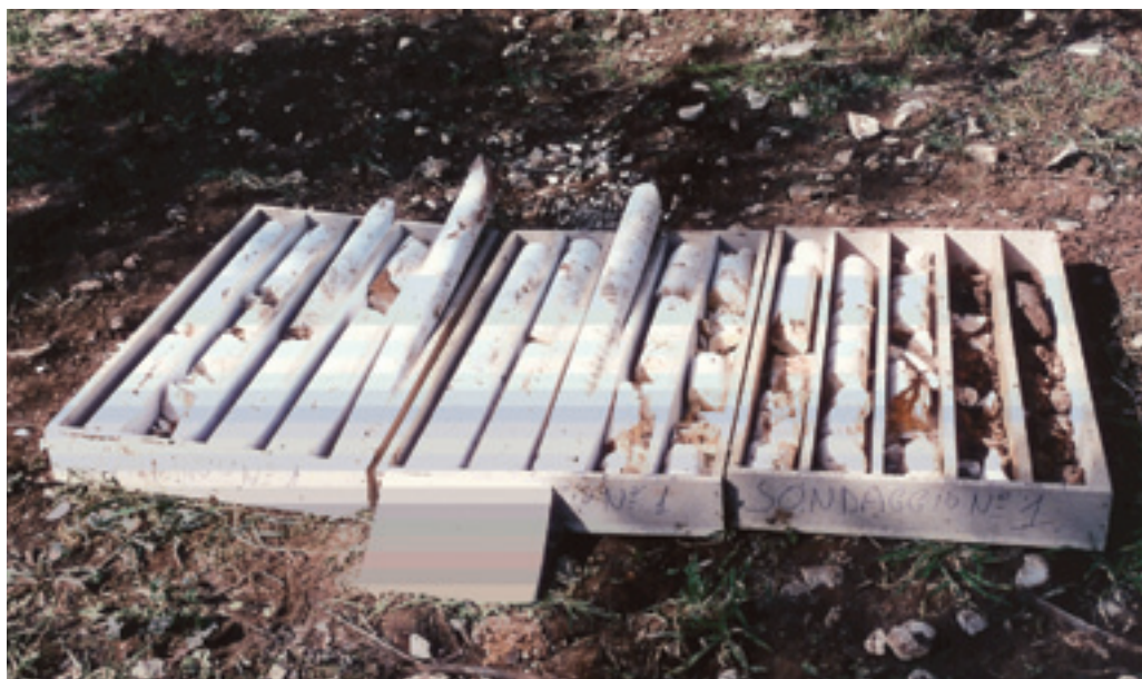
Figura 6 - Sondaggio meccanico a carotaggio continuo eseguito nei pressi della Nuova Stazione di Sannicandro: si noti l'elevata percentuale di carotaggio e i significativi valori di RQD dei livelli correlabili con il Perlato Svevo.
