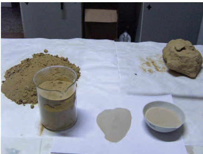
Foto 8 – Una fase delle ricerche in corso. Analisi granulometriche di campioni di depositi sabbiosi affioranti nel Tavoliere del Salento
