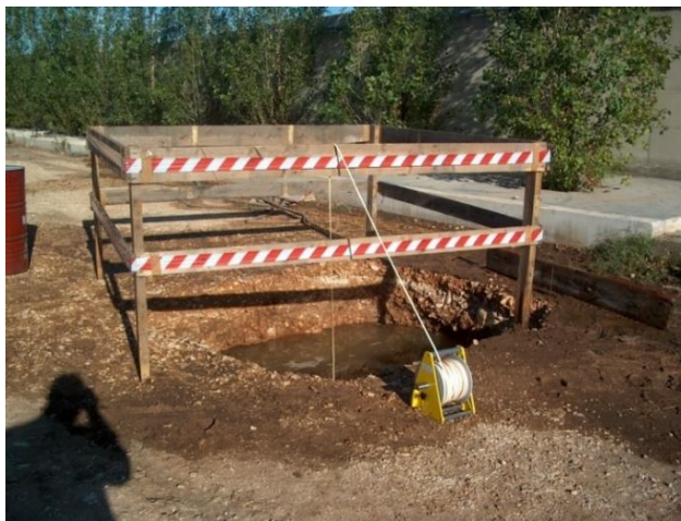
Fig.2. Prova di permeabilità a carico variabile in pozzetto a base quadrata.
