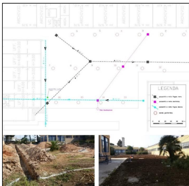
Fig. 4. Immagini relative all'impianto geotermico presso l'immobile ex CIAPI, nella zona industriale di Bari.
